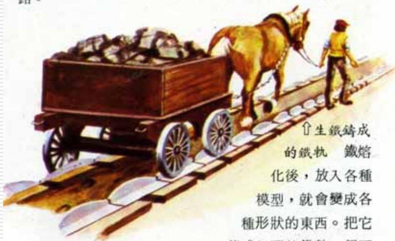
↑生鐵鑄成的鐵軌 鐵熔化後，放入各種模型，就會變成各種形狀的東西。把它鑄成L型的鐵軌，便可以防止車輪的脫軌。
