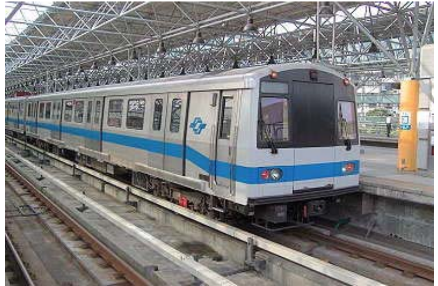
臺北捷運電聯車 最高車速：80公里/小時 製造廠商：德國西門子 製造年份：1998
