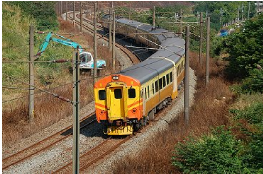
臺鐵自強號電聯車 最高車速：120 公里/小時 製造廠商：英國GEC製 製造年份：1979
