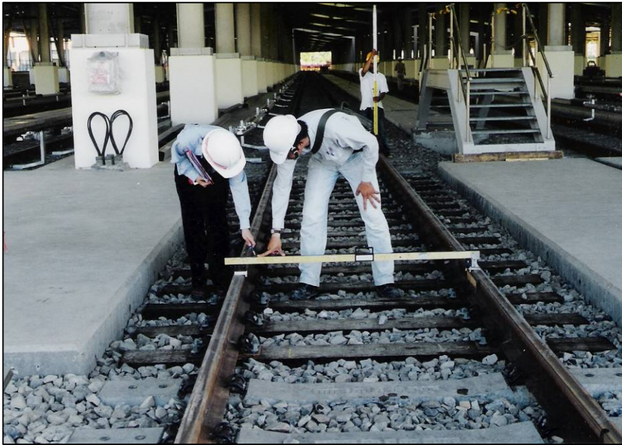
圖23 軌距量測 (軌距： 1435\pm 1.5\text{mm} )
