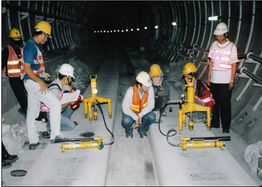
圖17 錨定套管拉拔試驗 (扣件錨定套管：50kN) (三軌錨定套管：22kN)
