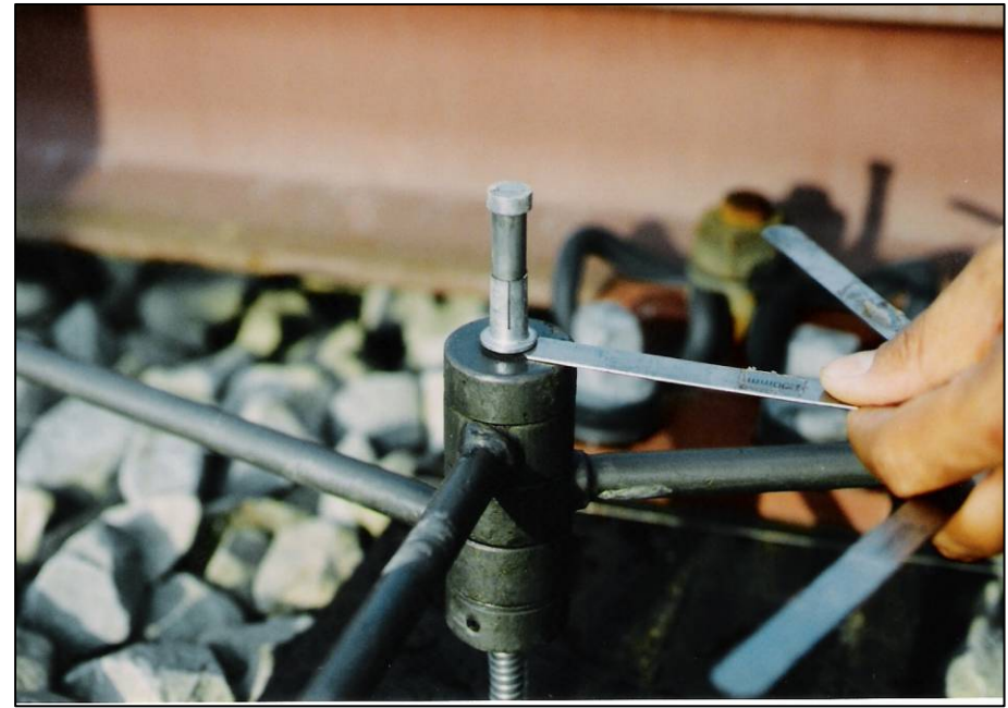
圖18 道碴沉陷量量測 (沉陷量須 \leq 2\text{mm} )
