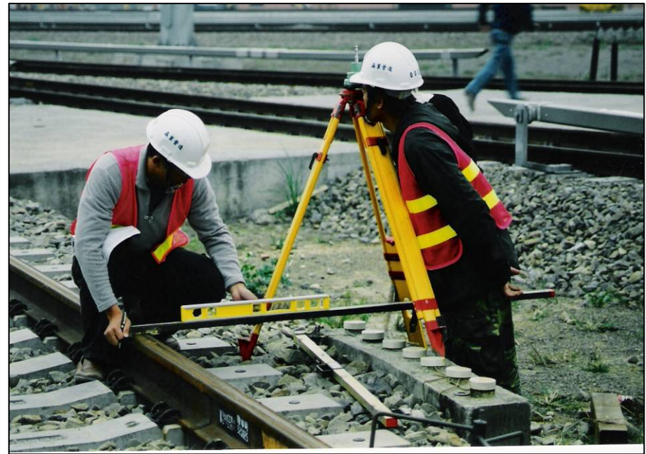
圖22 水平線形檢測 (量測值應在設計值 \pm 3\text{mm} )
