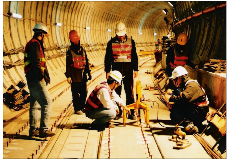
圖4 結合釘拉拔試驗 (抗拉拔力 \geq 8\text{kN} )
